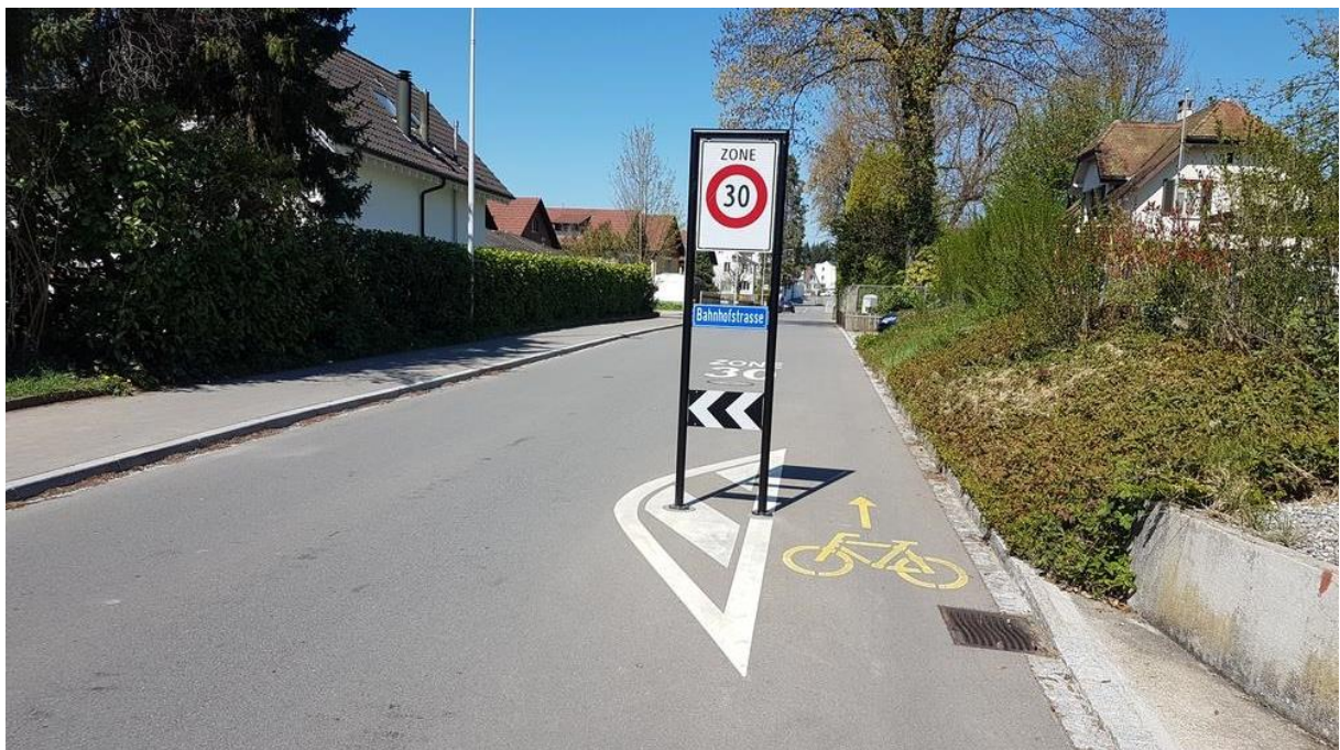
Abb. 13: Beispiel Torsituation in Othmarsingen (CH) mit Radbypass (Quelle: www.bikeable.ch )
